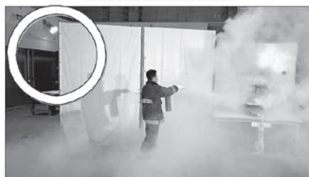
窒息効果で消火するので、再発火の可能性がります。消火器に充填された薬剤を最後まで放射して下さい。
